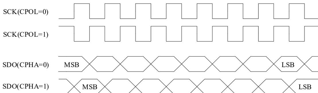
图10- 2 SPI 主控制器接口时序
