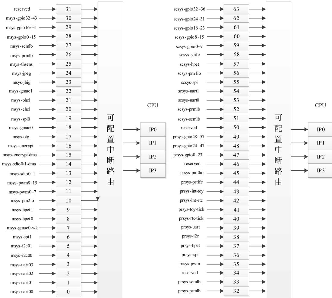
图5- 2 主系统传统 IO 中断路由示意图
