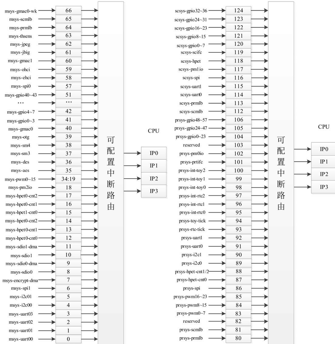
图5- 3 主系统扩展 IO 中断路由示意图
