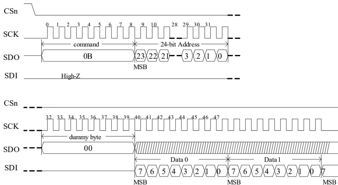
图10- 4 SPI Flash 快速读时序
