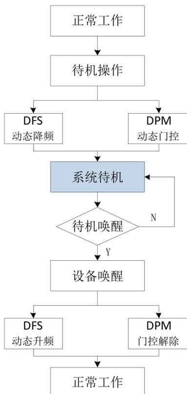
图25- 6 芯片待机唤醒操作流程
