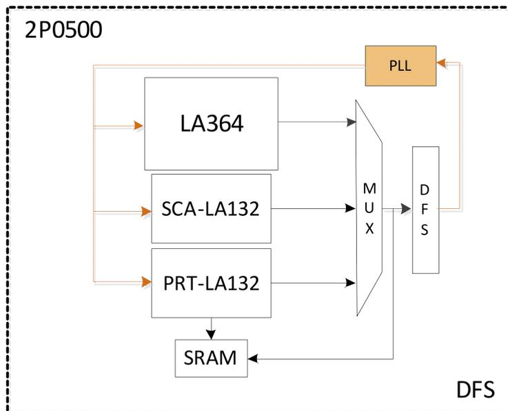
图25- 2 处理器核 DFS 控制结构框图
