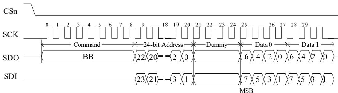
图10- 5 SPI Flash 双向 I/O 读时序
