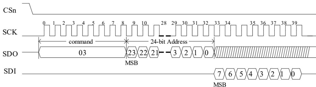
图10- 3 SPI Flash 标准读时序
