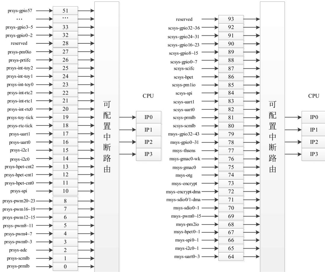
图5- 4 打印系统 IO 中断路由示意图
