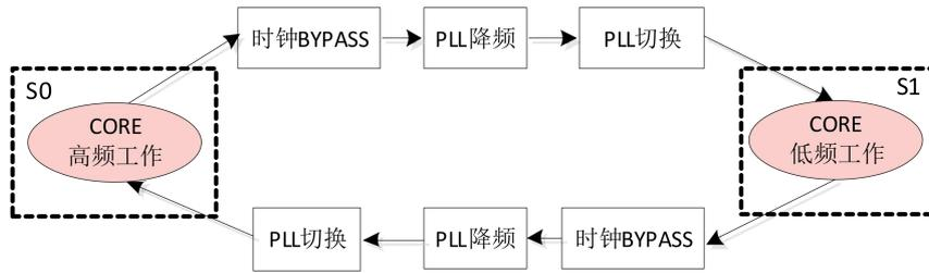
图25- 3 处理器核 DFS 操作流程图
