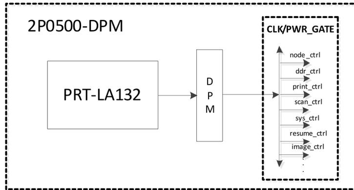
图25- 4 设备 DPM 控制结构框图
