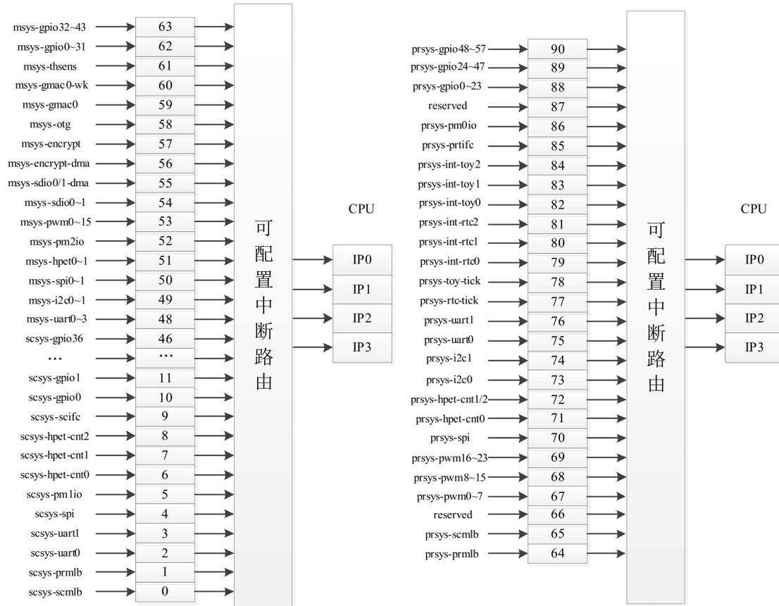
图5- 5 扫描系统 IO 中断路由示意图
