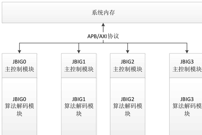
图17- 1 JBIG85 解码结构示意图
