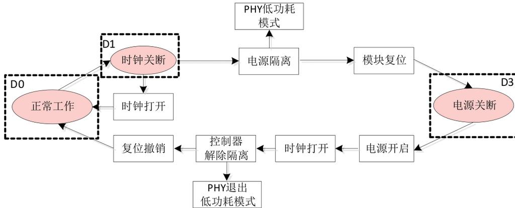
图25- 5 功能模块 DPM 状态切换流程图
